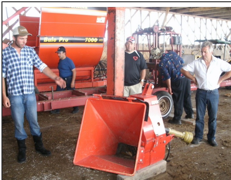
Photo 12: Alexis Fortin nous montre leur déchiqueteuse, qu'ils utilisent pour fabriquer eux-mêmes les copeaux de bois dont ils ont besoin. Ceux-ci forment une litière très portante pour les enclos extérieur d'hiver. En arrière plan, on voit également le moulin à scie que possède la Ferme Fortin-Farrell.
